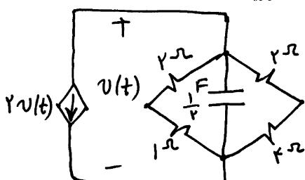
مدار پس از سری و موازی کردن مقاومتها به شکل زیر در می‌آید.
