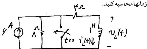
الف)  $t < 0$ : مدار به شکل زیر است. سلف در حالت پایدار و اتصال کوتاه است:
