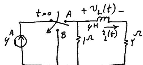
الف)  $t < 0$ : مدار به شکل زیر است. سلف در حالت پایدار و اتصال کوتاه است:
